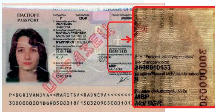
4. ábra: mechanikus perforáló berendezésekkel szemben a sokoldalú, valamint egyedi felhasználhatóságában rejlik (4. ábra). Lézerperforált másodlagos kép [2]
